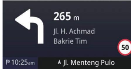
En el modo “Turn-by-Turn (Indicaciones paso a paso)”: Mueva el joystick a la izquierda-derecha para recorrer la información en la parte inferior de la pantalla entre la distancia restante hasta el destino/hora estimada de llegada y la posición actual.
