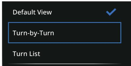
Este menú cambia el modo de visualización del sistema de navegación (Default View (Vista predeterminada)/Turn List (Listado de indicaciones)/Turn-by-Turn (Indicaciones paso a paso)). Después de seleccionarlo, se abre la pantalla de navegación en el modo de visualización seleccionado.
