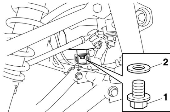
1. Perno de drenaje del depósito de aceite de motor
