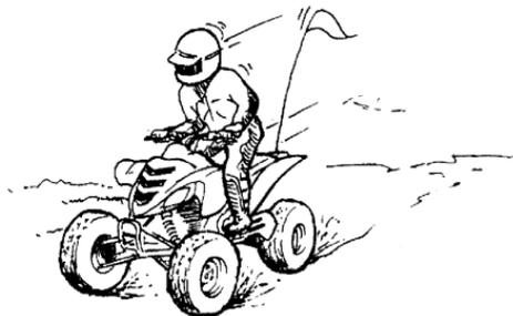
Si las ruedas traseras del ATV comienzan a patinar en sentido lateral, generalmente se puede recuperar el control girando la dirección (si hay suficiente espacio para ello) en el sentido del derrape. No se recomienda acelerar ni frenar hasta haber corregido el derrape.
