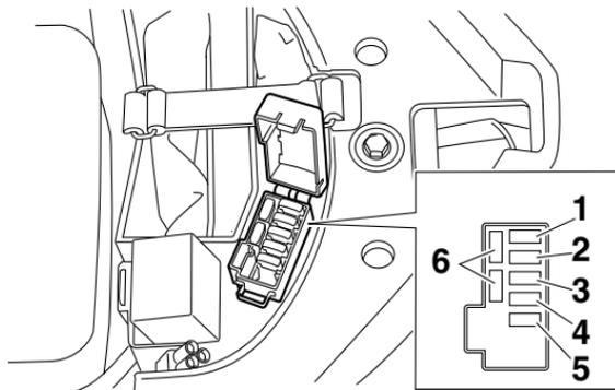
1. Fusible del sistema de inyección
