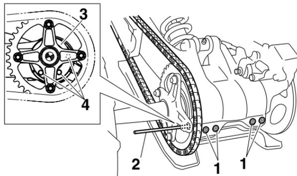
1. Remache de plástico desmontable del eje de la rueda trasera
