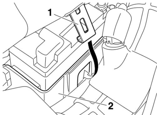
1. Placa de sujeción de la batería
