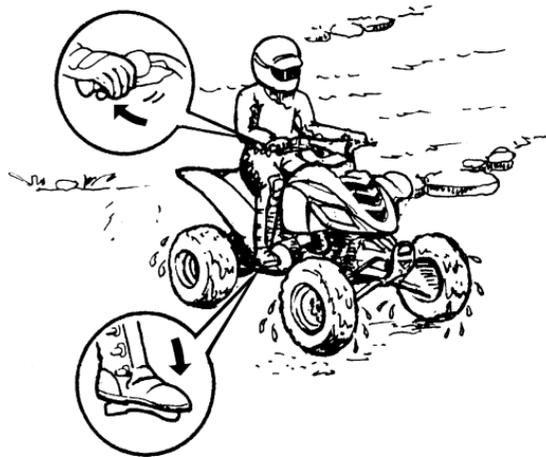
Después de conducir el ATV por el agua, elimine el agua atrapada, desmontando para ello el manguito de retención situado en el fondo de la caja del filtro de aire. **ATENCIÓN: El agua acumulada puede ocasionar averías o fallos.** [SCB00842]
