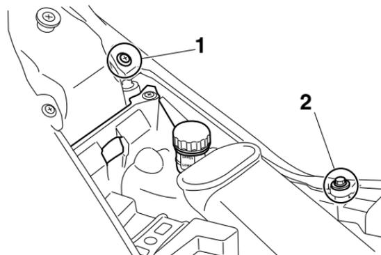
1. Tornillo de fijación rápida
