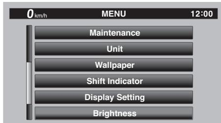
2. Para seleccionar el nivel de brillo que desee, gire el interruptor giratorio y luego presiónelo brevemente para fijar el ajuste.
